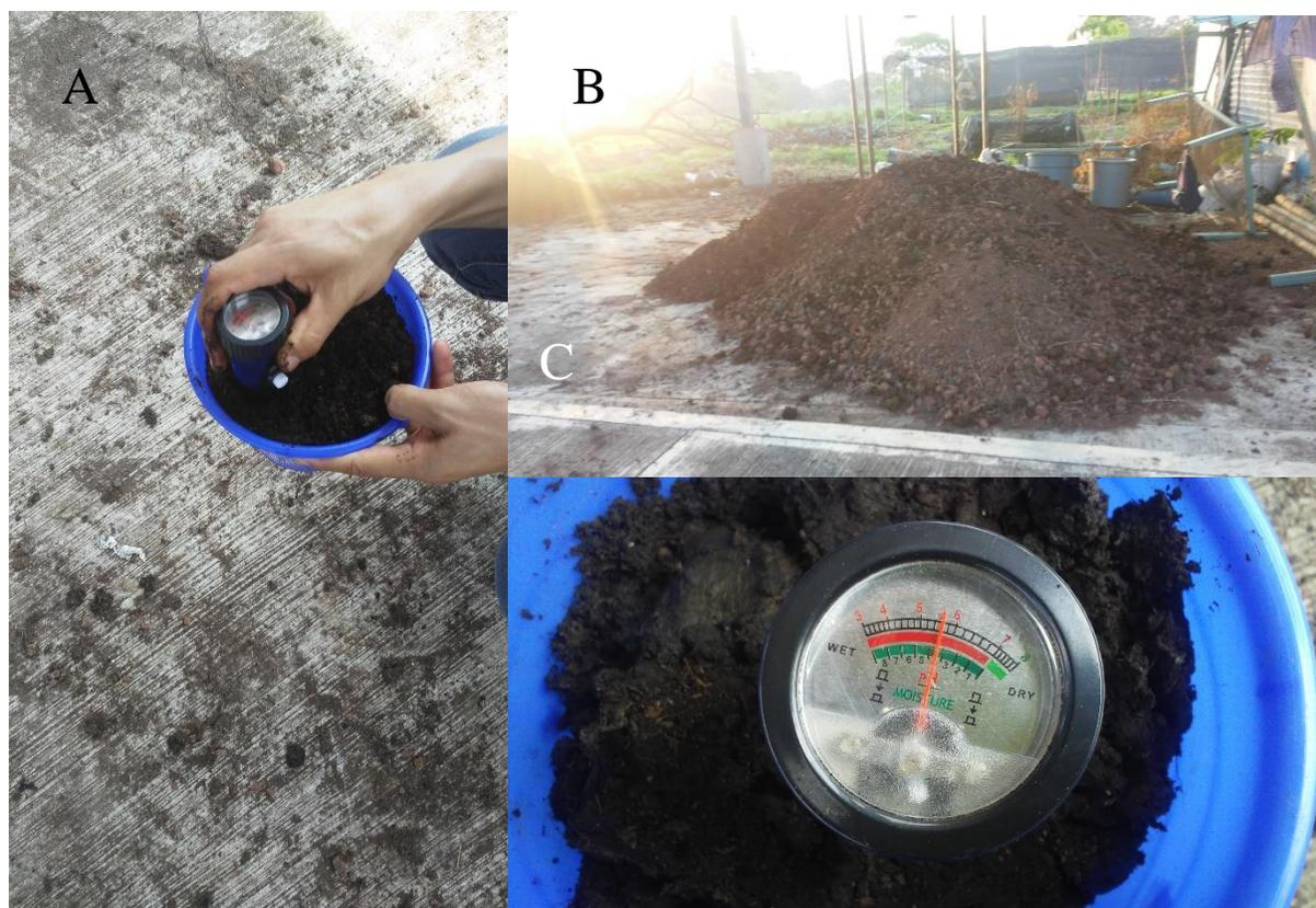
Figura 110. a: Prueba de campo para medir el pH del sustrato; b: Sustrato utilizado para el experimento; c: Se puede observar una medida de 5.5 en escala de pH en el potenciómetro sobre la muestra.
